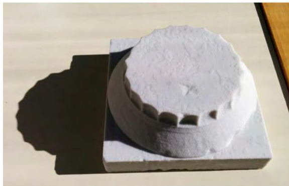
Εικόνα 17 3D εκτύπωση σε κλίμακα 1:20 του τελικού μοντέλου επιφάνειας που προέκυψε από την 3D σάρωση δύο αρχιτεκτονικών μελών.
