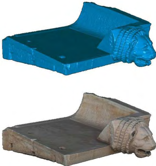
Εικόνα 12 Απόδοση φωτογραφικής υφής στο 3D μοντέλο τριγώνων (3D mesh model) από 70 περίπου επικαλυπτόμενες εικόνες.
