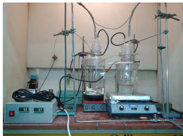
Εικόνα 2 Πειραματική συσκευή τεχνητής γήρανσης.
